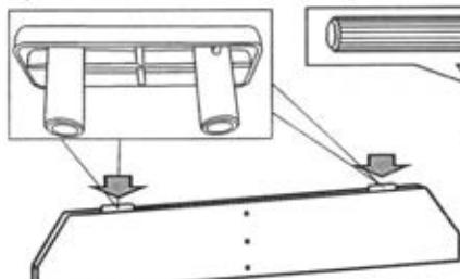
В отверстия на кромке опорных стенок установить наконечники.
