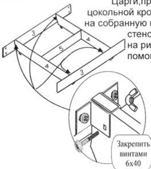
Царги, предварительно оборудованные цокольной кроватной стяжкой, установить на собранную конструкцию из опорных стенок и закрепить, как показано на рисунке, винтами 6x40 при помощи барабановой гайки.
