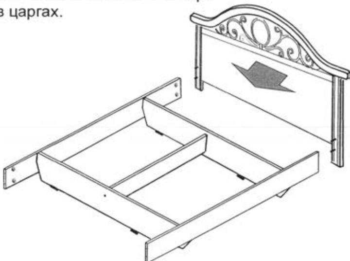
Установить сегмент Рис 1. Винт стяжки затянуть любым подходящим инструментом (гвоздь, шило). Установить заглушку, отогнув пластины на необходимое расстояние Рис 2.
