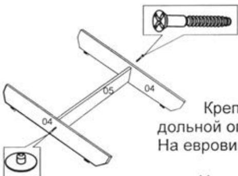
Крепить стенки опорные к стенке продольной опорной на шканты и евровинты. На евровинты установить заглушки.
