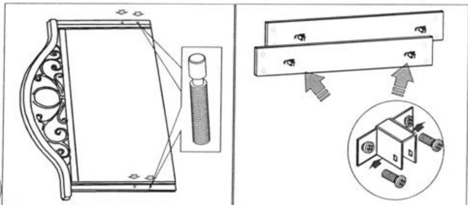
В гайки стоевых брусков головной спинки на 2-3 оборота ввернуть винты стяжки. Царги оборудовать цокольной кроватной стяжкой при помощи винтов 6.3x16.
